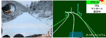
タブレットに障害物等を表示し、接近時にアラートを行う
