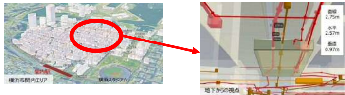
出典:国土交通データプラットフォーム 地下設備の3次元モデル構築(横浜市内・みなとみらい地区) https://www.mlit-data.jp/platform/showcase/case-1.html
