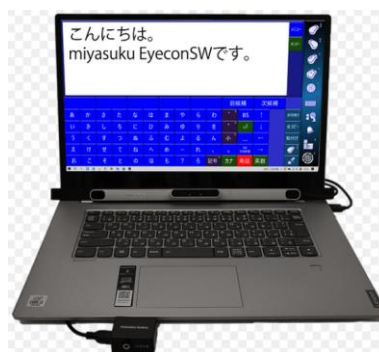
視線入力意思伝達装置 (写真提供: ㈱ユニコーン)
