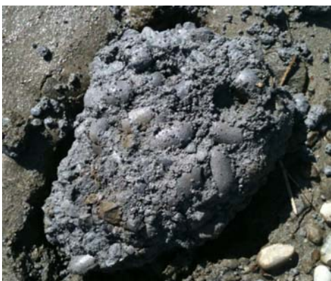
写真-4.1.3 微細粒子による石炭灰造粒物の凝結状況
