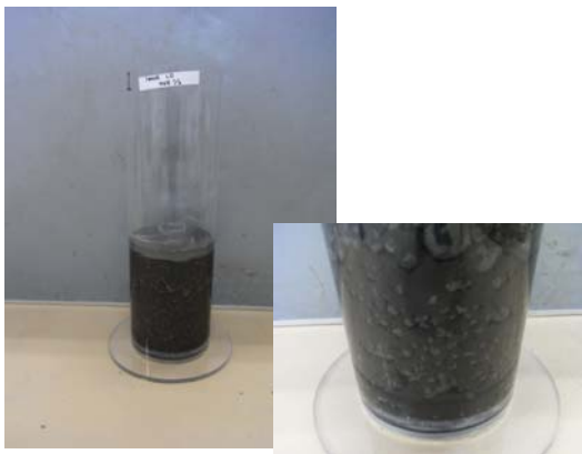
写真-2.4.1 石炭灰造粒物層内に泥が堆積した様子 (実験開始から3時間後)
