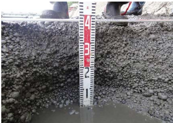
写真-6.1.1 石炭灰造粒物層の断面写真 9)
