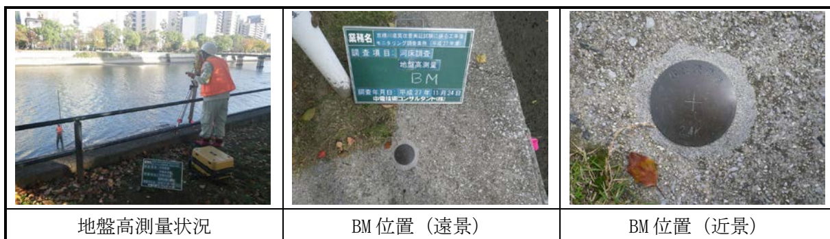
写真-6.4.2 地盤高測量（横断測量）状況
