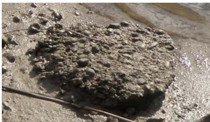
写真-4.1.3 微細粒子による石炭灰造粒物の凝結状況
