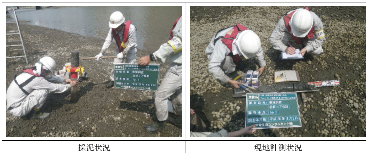
図- 6.1 被覆層内調査（柱状採泥）の実施要領
