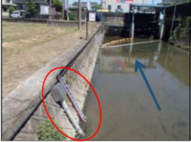
図. 福川水位計設置状況(0k200左岸) 図. テレメータ観測局・無線装置 図. 福川水位情報の公開(河川防災情報システムより)
