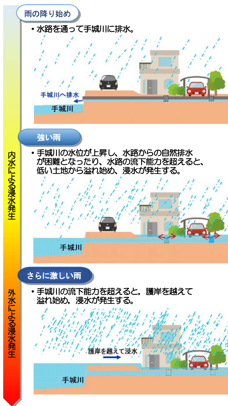
図 5.1 手城川流域における浸水発生メカニズム（イメージ）
