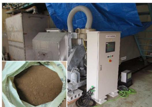
図1 減容化装置と竹チップ混合肥料(左下)
