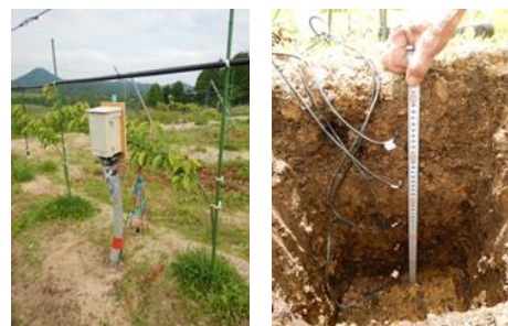
図2 土壌水分計測センサーの設置状況 （左：地上部、右：地下部）
