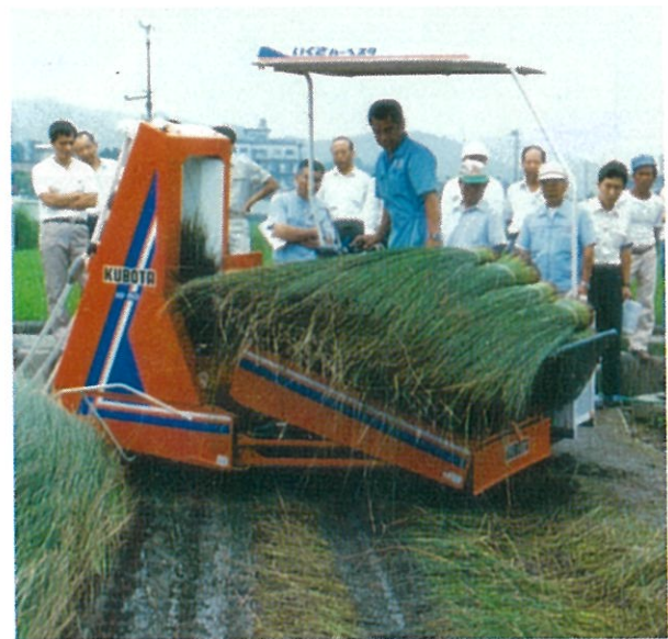
同機による束降ろし作業
