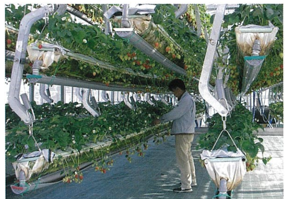
2段吊り上げシーソーシステムの試作装置
