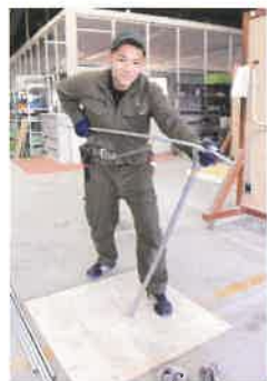
金属管曲げ作業
