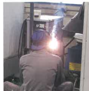
被覆アーク溶接作業
