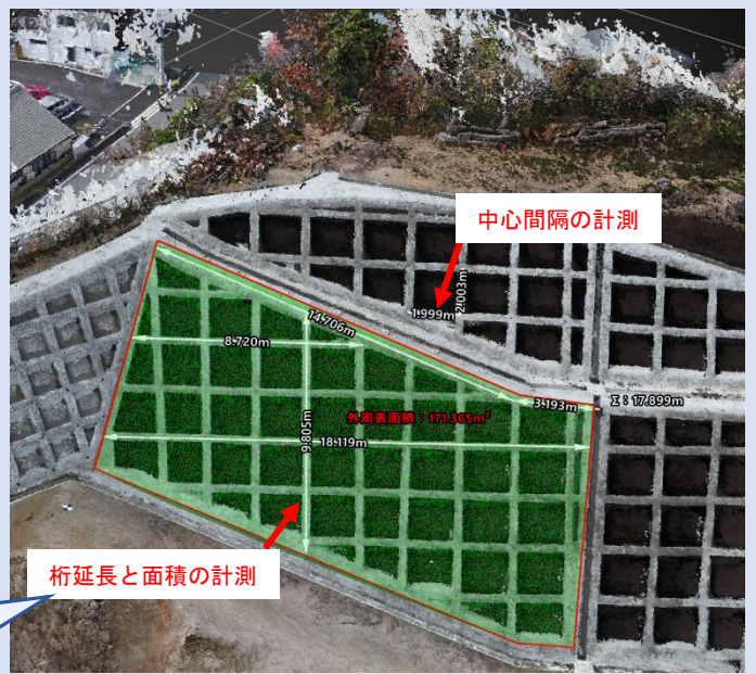
点群データを活用した出来形管理
