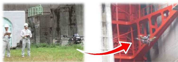
ドローンを活用した施設点検
