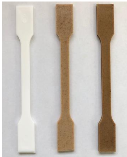
写真1 試作したダンベル試験片 おが屑添加量 0, 10, 20 wt%
