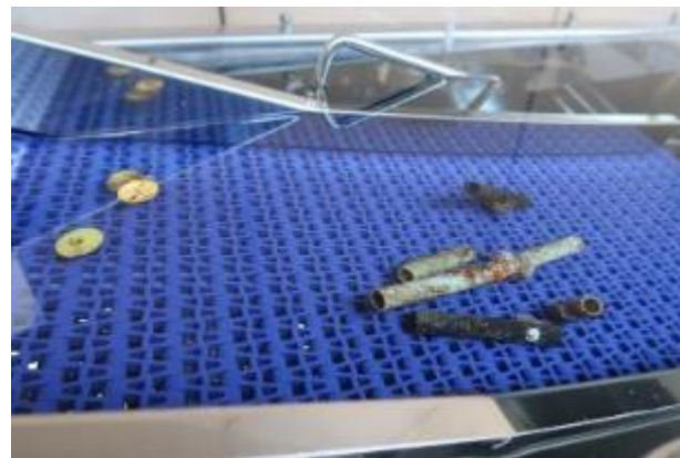
フジツボ、泥が付着したパイプは沈む
