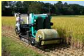
収穫機でロール成形されたものをラッピングし密封
