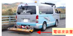
＜橋梁床板の診断技術＞
