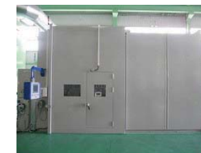
HVOF 溶射装置 2 φ400×L2,000 mm Max.150 kg)
