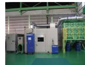
HVOF 溶射装置 1 (φ200×L800 mm Max.30 kg)
