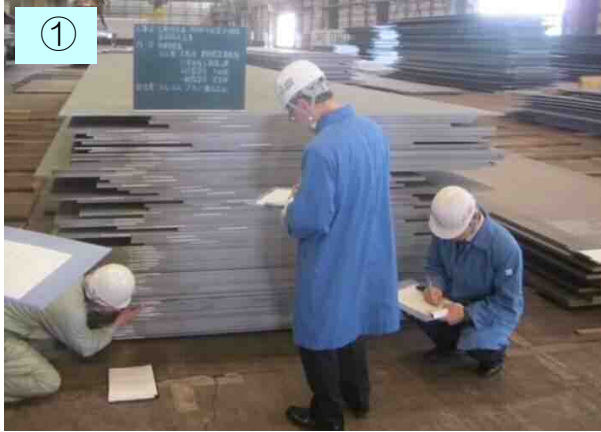
橋の設計を行い、必要な鉄板の厚さを計算し、製鉄所にて橋の材料となる鉄板を製作します。
