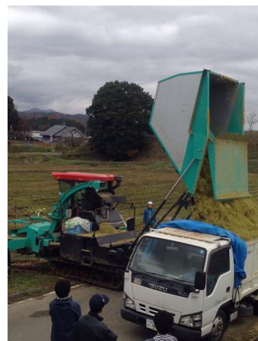
微細断収穫機のダンプボックスからのトラックへの積み込み
