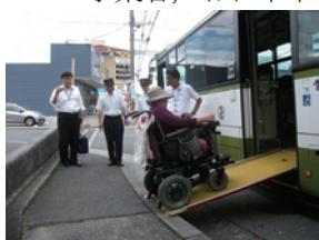
①電動車椅子で自走可能な低床バスの補助スロープ板の勾配を調査。
