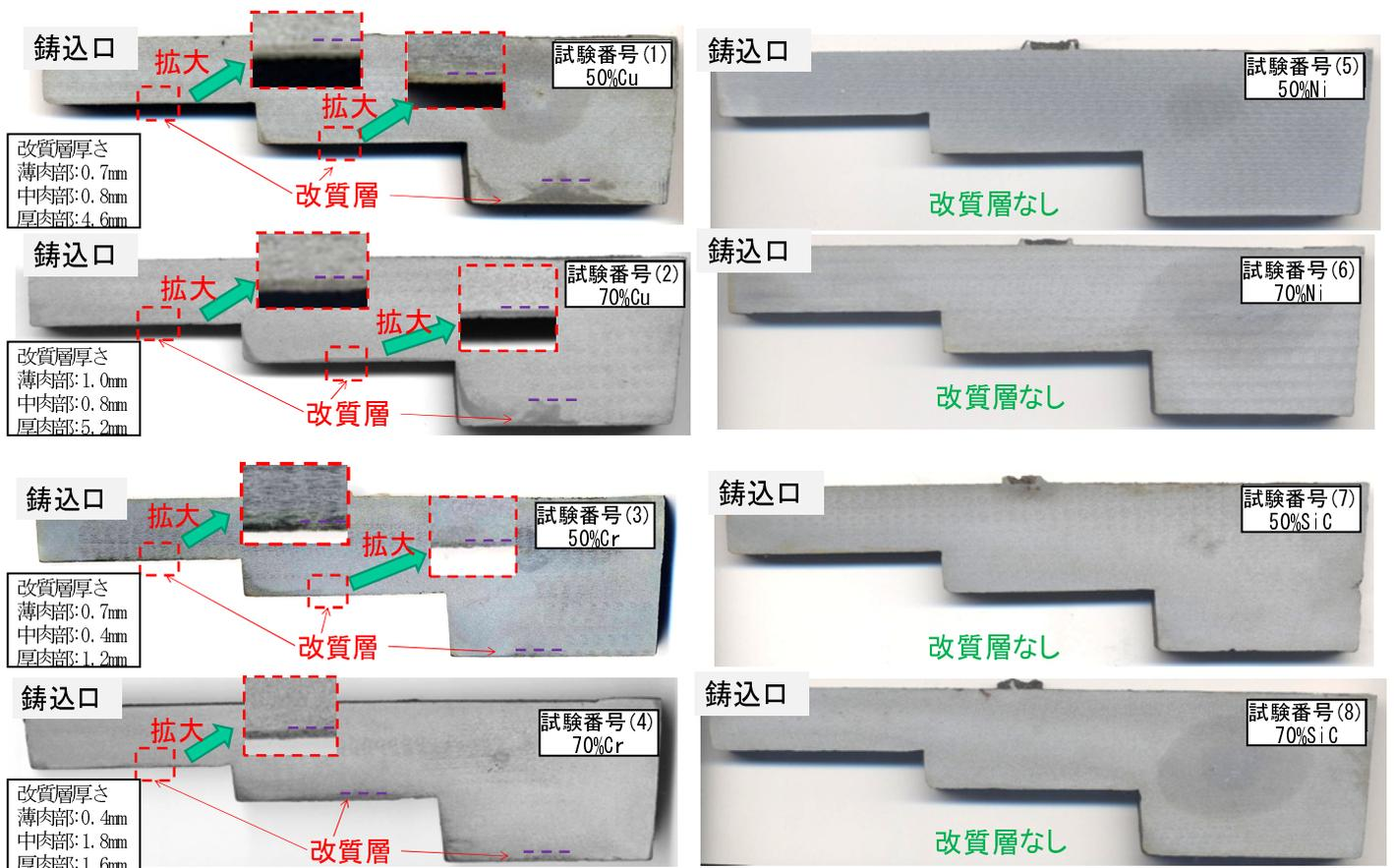
図2 各条件における改質実験のマクロ観察結果
