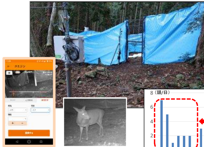
スマートフォンで捕獲できるIoT自動捕獲装置の設置状況 [上] 囲いわなと自動捕獲装置 [左下] スマホの画面 [右下] 捕獲したシカ
