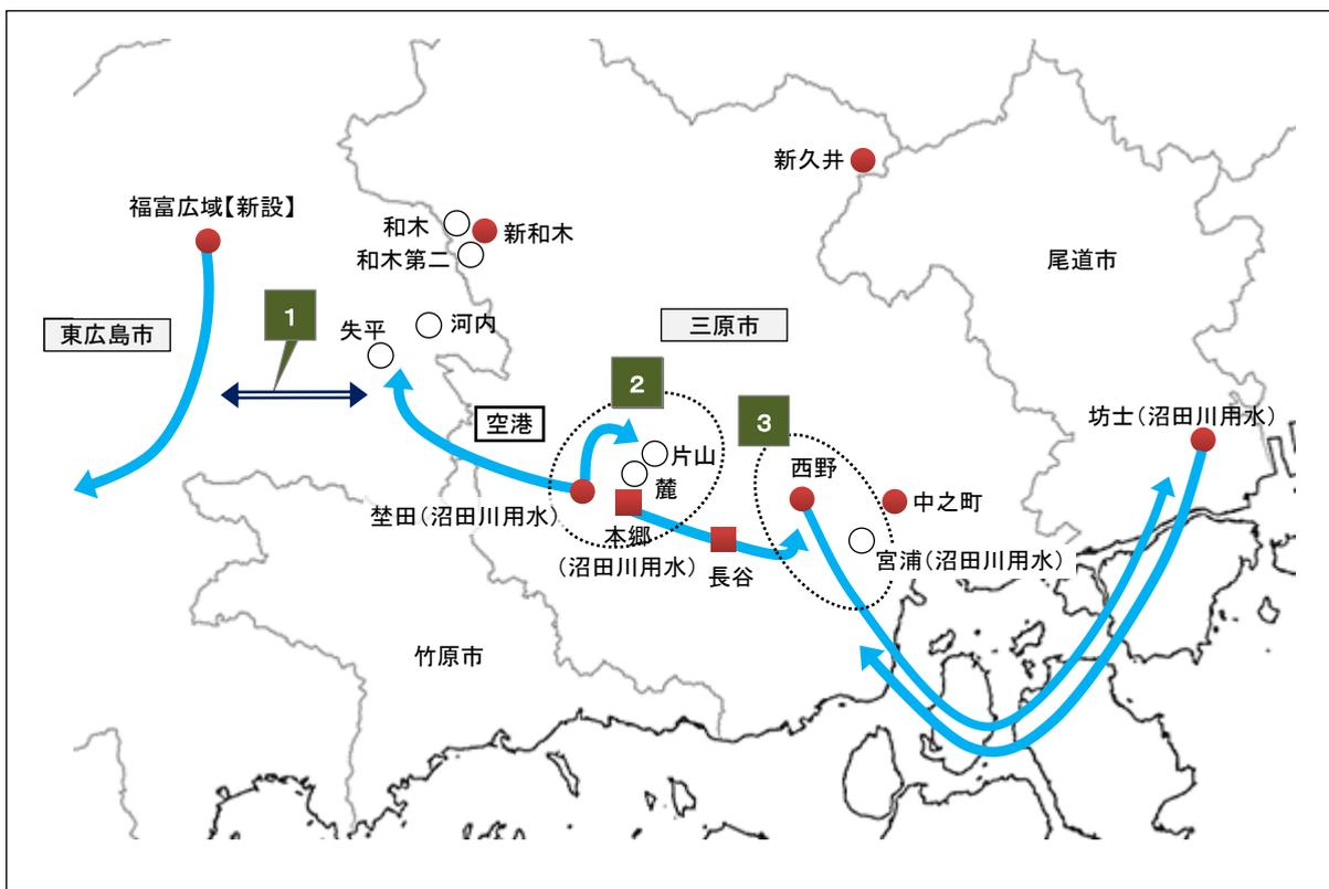
〔凡例〕 ■ 取水場 ● 浄水場 ○ 廃止浄水場 → 主な送水ルート
