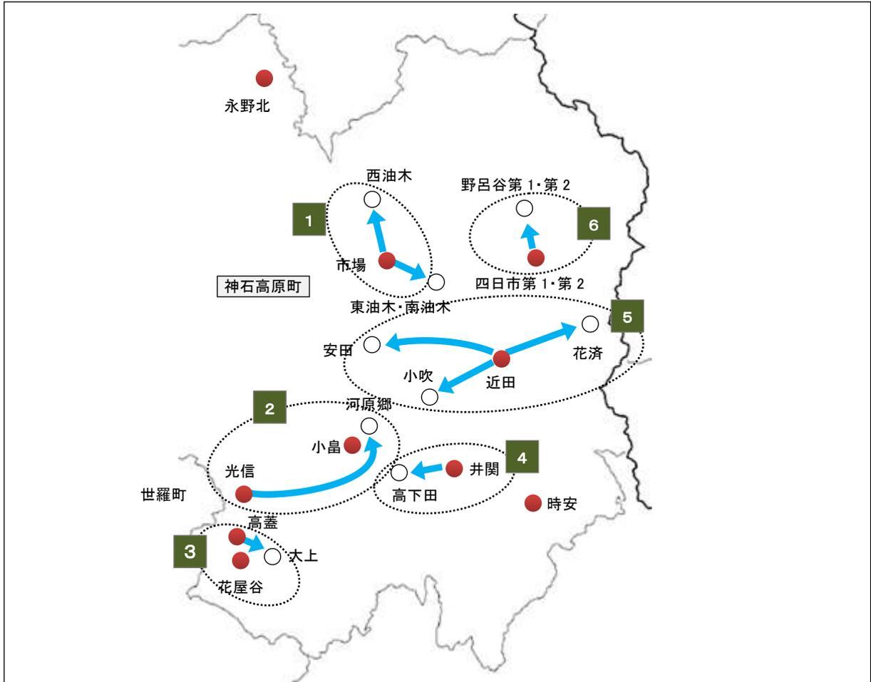
〔凡例〕 ■ 取水場 ● 浄水場 ○ 廃止浄水場 → 主な送水ルート
