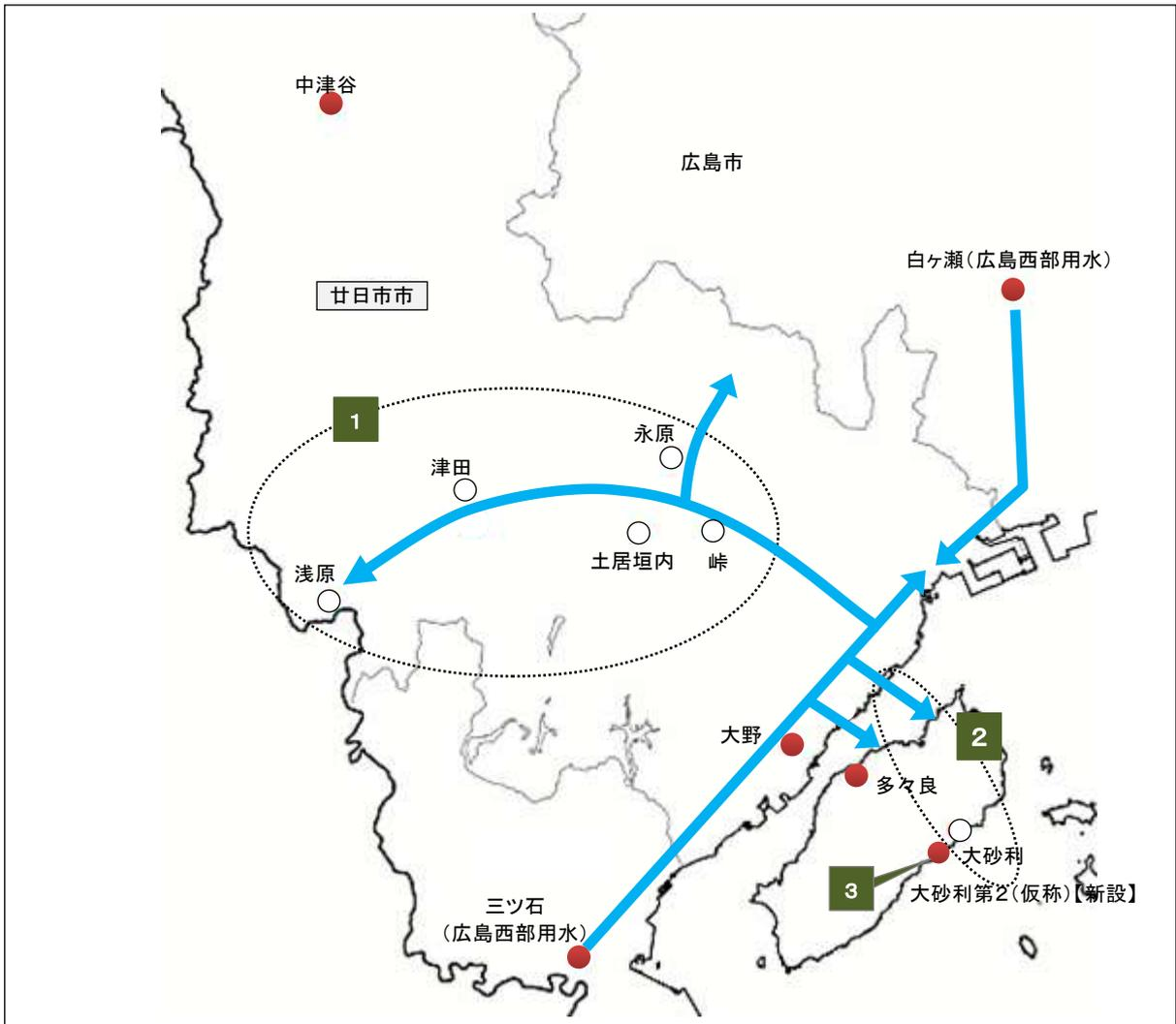
〔凡例〕 ■ 取水場 ● 浄水場 ○ 廃止浄水場 → 主な送水ルート
