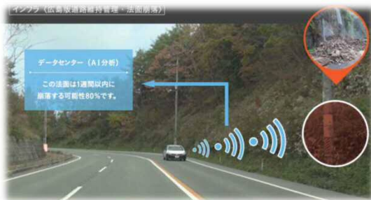
道路法面の崩落予測技術
