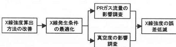
図2 測定精度向上へのフローチャート
