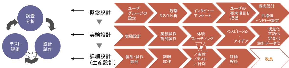
図1 再構築した開発フロー
