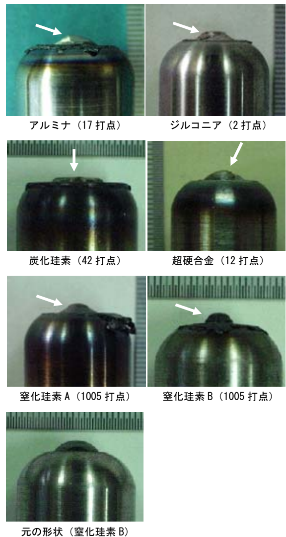
図 15 接合後のツール外観
