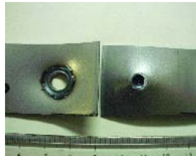
図9 せん断引張試験後の試験片
