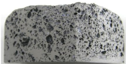
図1 半凝固アルミニウム合金を用いた多孔質金属材料の断面写真
