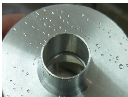
写真4 防汚試験後の状態（緩衝体有り）
