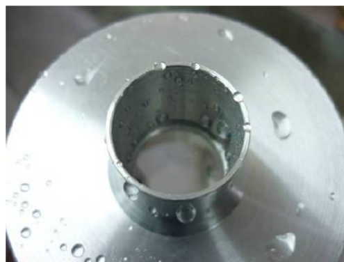
写真5 防汚試験後の状態（緩衝体無し）
