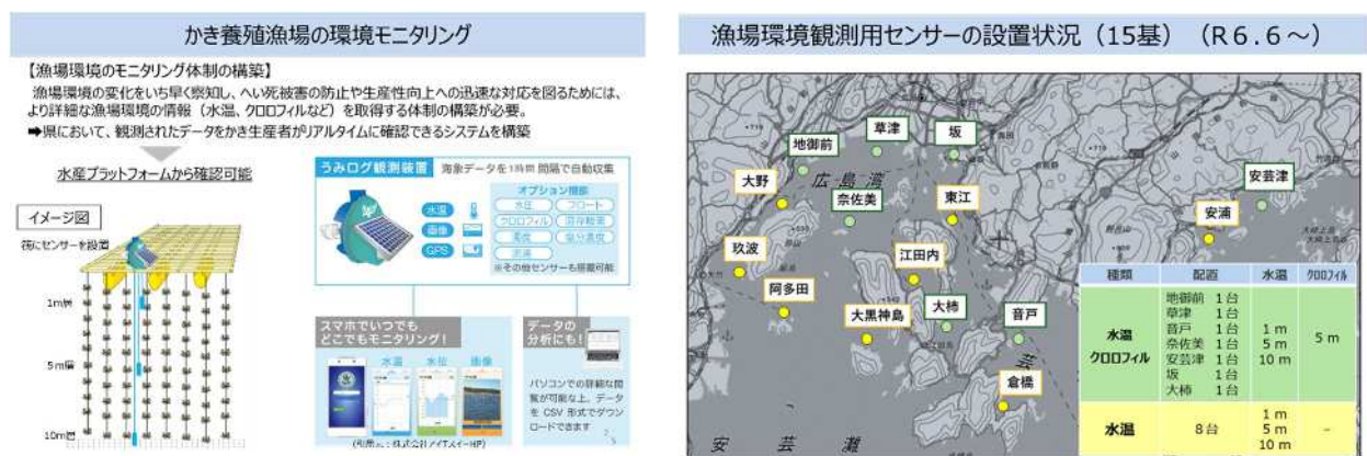
【図1 漁場環境モニタリングのシステム構築と水温等センサーの配置状況】
