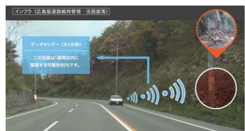
【AIを活用した道路法面点検】
