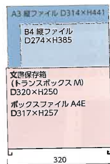
棚板Cタイプ (W854×D320、60kg/段、標準6段) A4判ファイル (ヨコ置き)、文書箱等
