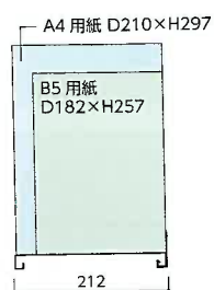
棚板Aタイプ (W854×D212、40kg/段、標準7段) B5判までの図書、ファイル、A4用紙等
