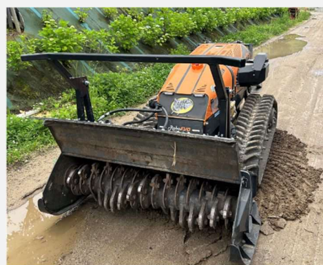
県内に導入された自走式下刈り機 (スマート林業機械)
