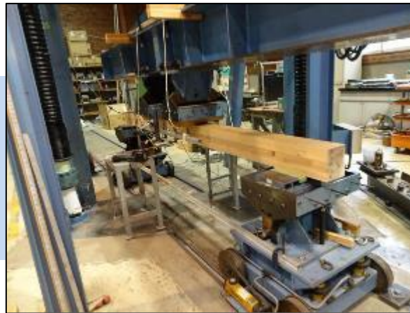
曲げ強度試験（3等分点4点荷重，支点間距離2700mm）
