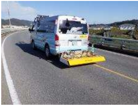
図Ⅱ－１０ 床版点検車とその解析画像
