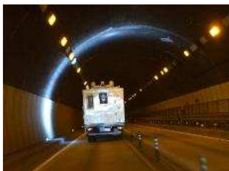
図Ⅳ－7 走行計測車両による覆工画像撮影状況
