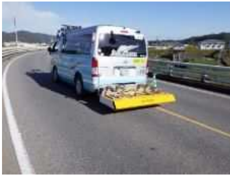
図Ⅱ－１０ 床版点検車とその解析画像
