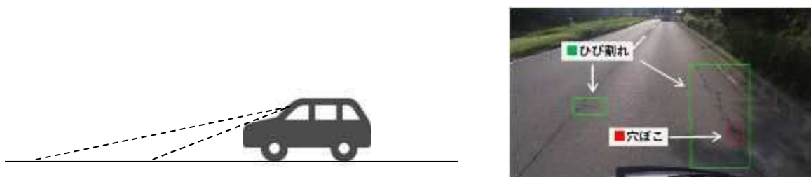
図IV-7 ドライブレコーダーの画像解析による点検イメージ
