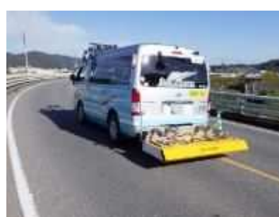
床版点検車による点検（委託）
