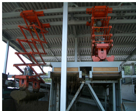
バケット開閉油圧システム
