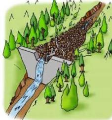
②大雨が降り土石流が発生したとき、堰堤背面に堆積した土砂によって勾配が緩くなることにより、流下する勢いが減少することで大きな岩、流木などを含む土砂のため、下流への被害を防ぎます。(下図赤色部分)
