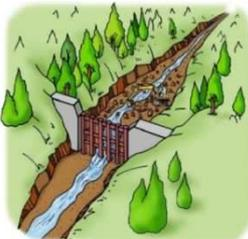
③堰堤にたまった岩、土砂や流木は、次の土石流に備えて取り除きます。(下図破線部分)
