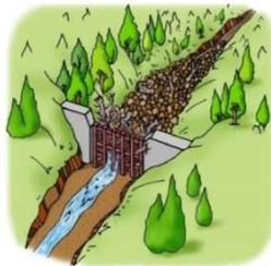
②大雨が降り土石流が発生したとき、大きな岩、流木などを含む土砂は堰堤に引っ掛かり止まります。(下図赤色部分)
