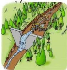
③土石流等により堰堤にたまった土砂は、流域の状況によって緊急的に除石が必要と判断される場合、次の土石流に備えて取り除きます。(下図破線部分)
