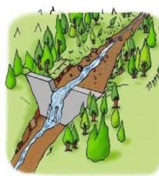
①不透過型砂防堰堤を設けると、堰堤の上流側に土砂が少しずつたまっていきます。
