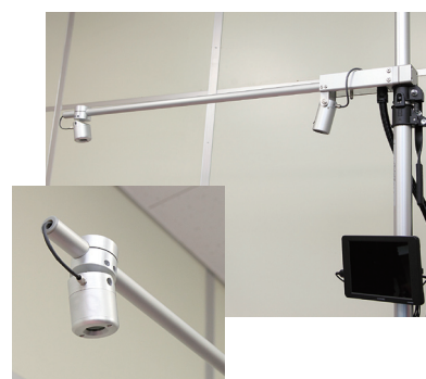
アーム先端から赤外光を照射し、基部のカメラで撮影した画像から動きを解析
