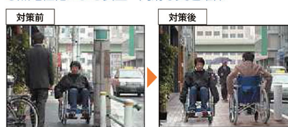
移動円滑化を妨げる電柱
