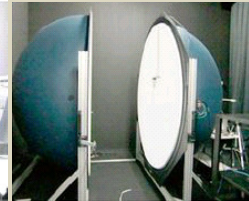
照明器具測光装置(東部工業技術センター)
