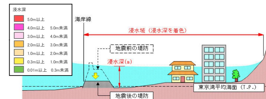
堤防等の耐震性等が十分でない場合(耐震工事中のものも含む)、地震により破壊され、地域によっては津波が襲来する前に浸水が始まることがあります。
