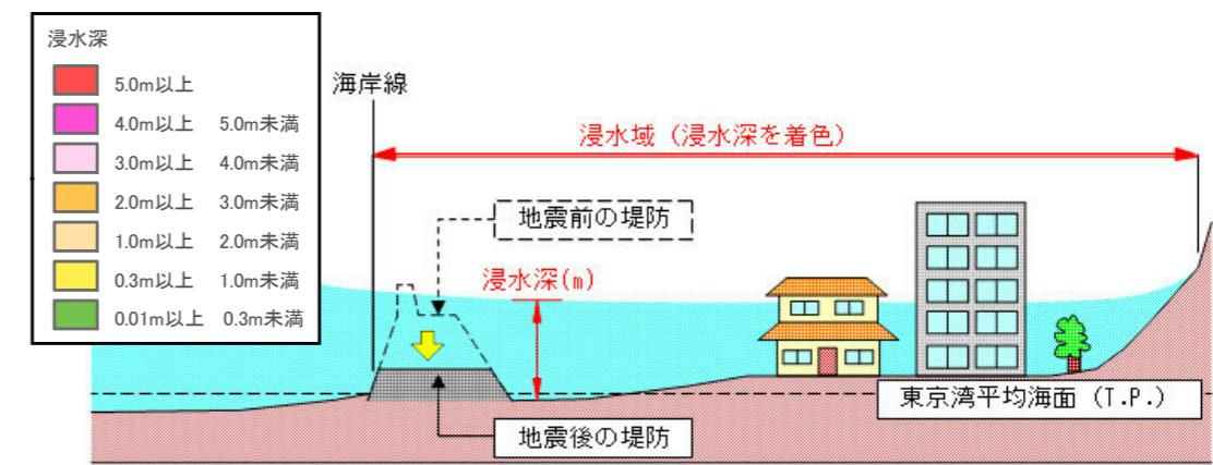
堤防等の耐震性等が十分でない場合(耐震工事中のものも含む)、地震により破壊され、地域によっては津波が襲来する前に浸水が始まることがあります。
