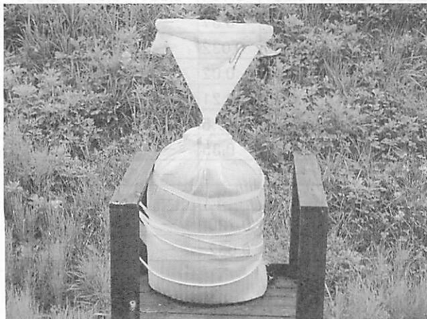
写真5 簡易式雨水採水の設置状況
