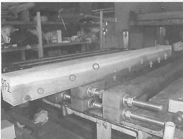
写真1 材料側面に空けた貫通穴（赤丸及び矢印部分）
