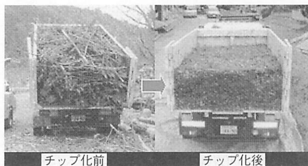
写真-4 チップ化による減容化状況
