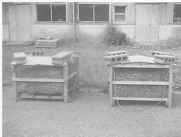
写真-10 チップの金網籠での屋外保管状況
