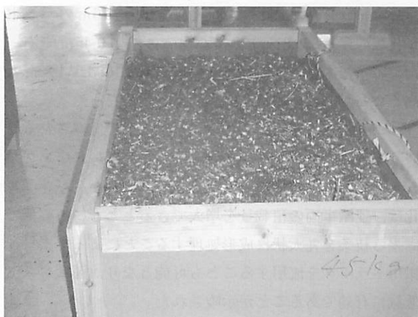
写真-9 チップの木箱での屋内保管状況
