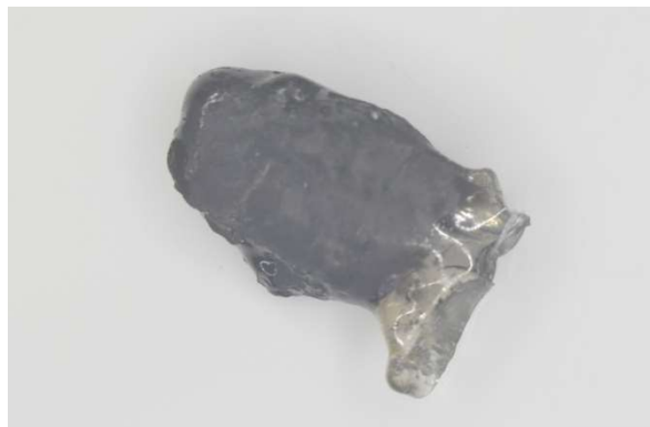
写真8 ポリスチレンの溶けた塊
