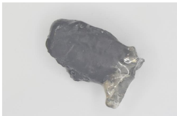
写真8 ポリスチレンの溶けた塊
